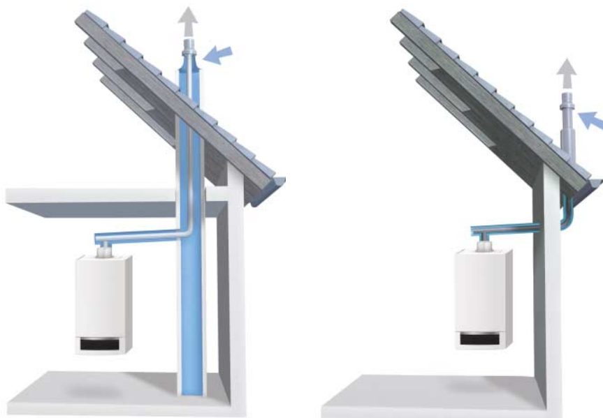
Varianta nezávislá na vnitřním vzduchu se zavedeným odkouřením z plastu v komíně (vhodná pro nasávání vzduchu kruhovou mezerou šachty)
